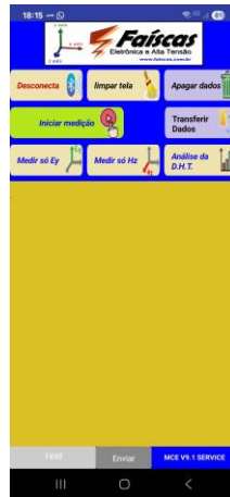
Figura 15 – tela do aplicativo com o MCE-3D devidamente conectado ao celular e aguardando comando. Observe que o botão pressionado inicialmente agora apresenta em letras vermelhas a palavra “Desconecta”
